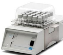
Ermöglicht dem Anwender die Bestimmung von Parametern wie CSB, nitrogenen und phosphorylierten Verbindungen. Fisherbrand ECO 25 Thermoreaktor für die CSB-Analyse ermöglicht die Vorbereitung von Proben mittels Nassaufschluss zur Bestimmung von metallischen und nichtmetallischen Elementen in organischen und anorganischen Materialien.
