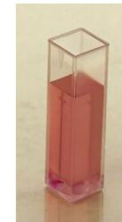
Diese Küvetten gewährleisten konstantere Probentemperaturen während der photometrischen Messungen. Fisherbrand Makroküvetten aus Polystyrol für Wellenlängen im sichtbaren Bereich gewährleisten einen ausgezeichneten Transmissionsbereich sowie verbesserte Wärmeübertragung dank der dünnen Wände.
