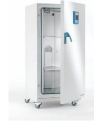
Führen Sie eine Reihe von Routine-Anwendungen mit Thermo Scientific Heratherm General Protocol mikrobiologischen Inkubatoren durch. Die Produktreihe der Heratherm General Protocol Inkubatoren wurde für Anwendungen in pharmazeutischen, medizinischen, Lebensmittel- und Forschungslabors entwickelt und bietet eine zuverlässige Inkubation.
