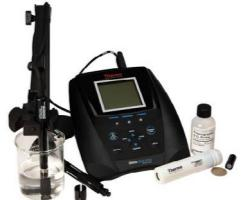
Mit dem Thermo Scientific Orion Star A213 RDO/DO Tischmessgerät für erweiterte Laboranalysen können Sie den gelösten Sauerstoff (RDO-optisch/polarografisch) und die Temperatur zuverlässig messen.
