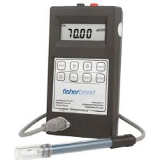
Ermöglicht direkte digitale Messungen von Leitfähigkeit, Widerstand und gelösten Feststoffen. Fisherbrand Traceable Leitfähigkeits-, Widerstands- und TDS-Messgeräte sind ideal zur Messung von Wasser in Reagenzienqualität gemäß CAP, ASTM, NCCLS und ACS sowie zur Leitfähigkeitsmessung in Chromatographie, Biologie, Lebensmittel- Elektronik- und Wasseranalyse. Alle Messwerte beziehen sich automatisch auf den internationalen Standard von 25 °C.
