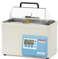
Geeignet für zahlreiche Anwendungsbereiche mit Allzweck-Wasserbädern und zur Aufrechterhaltung einer Temperatur von der Umgebungstemperatur bis 100 °C konzipiert. Die Hochleistungsbäder haben ein Volumen von 2 l bis 28 l.
