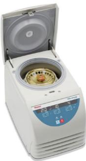
Zentrifugieren von 24 x 2 ml bei bis zu 21000 x g mit Kühlung, um die routinemäßige Vorbereitung von Mikrozentrifugenröhren zu beschleunigen.
