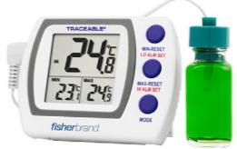
Mit dem in einer temperaturgepufferten Glykol-Lösung versiegelten Sensor gewährleistet das Thermometer genaue Messungen, wenn die Türen des Tiefkühlgeräts/Kühlgeräts geöffnet sind.
