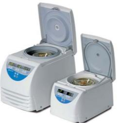
Auf bis zu 99 Minuten einstellbarer Zeitgeber und Quick-Spin-Funktion für kurze Läufe.
