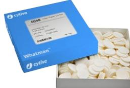
Filtermatte aus einer Mischung aus Zellulose und Polyester, die zur optischen Prüfung von Babynahrung (Kunstmilch) auf Textilfasern verwendet wird.
