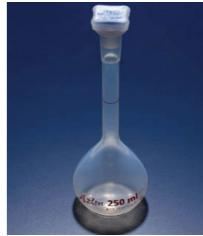
Der Azlon Messkolben Klasse A Polymethylpenten (PMP) enthält einen Polypropylen-Stopfen.
