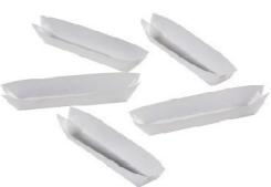
Schlüsselanwendung: Stickstoffanalyse. Übertragen Sie Ihre Proben vollständig verlustfrei, indem Sie einfach das gesamte Wägeschiff mit der Probe in die Säurelösung im Kjeldahl-Kolben-/Aufschlussrohr fallen lassen.
