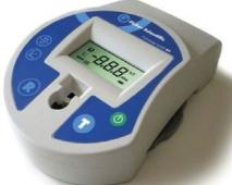
Für die schnelle und einfache kolorimetrische Messung von Lösungen und Flüssigkeiten.
