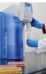
Umwandlung von Leitungswasser sowohl zu Typ 1-Wasser gemäß ASTM als auch Typ 2-Wasser mit dem kompakten All-in-One Thermo Scientific Barnstead Smart2Pure Wassersystem.
