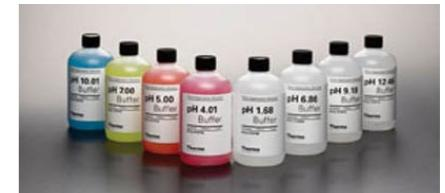
Führen Sie präzise, reproduzierbare Kalibrierungen von pH-Werten mit den farbkodierten Thermo Scientific Orion pH-Pufferflaschen durch.
