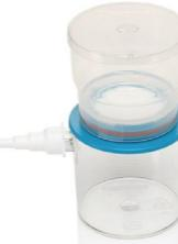
Für die Rückgewinnung und das Wachstum von Mikroorganismen in Prüfverfahren der Qualitätskontrolle und zur Analyse von Wasser, Lebensmitteln und Getränken, Rohstoffen und Endprodukten.
