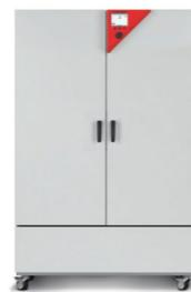
Temperaturbereich: 0 °C bis 70 °C; Feuchtebereich: 10 % r.F. bis 80 % r.F.
