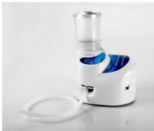
Die Sentino-Pumpe ersetzt herkömmliche Vakuumfiltrationssysteme für die Membranfiltration durch eine kleine peristaltische Pumpe und einen sterilen Einweg-Flüssigkeitsdurchgang.
