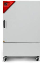
Die Feuchtigkeitsprüfкамmer der BINDER Serie KBF-S Solid.Line mit korrosions- und kondensationsfreiem Innenraum für stabile Temperatur- und Feuchtigkeitswerte ist ideal für langfristige und beschleunigte Stabilitätstests pharmazeutischer Produkte.
