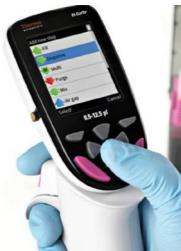
Übertragen Sie Proben zwischen praktisch allen Röhrchen, Racks, Mikrotiterplatten oder horizontalen Gelboxen schnell und effizient mithilfe des einstellbaren Pipettenspitzenabstands.
