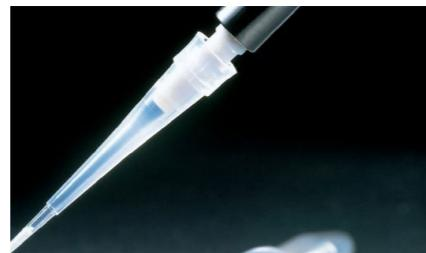
Probenvorbereitung und präzises Liquid-Handling mit einem Gerät. Ein 0,6 µl-Bett aus C<sub>18</sub> C<sub>4</sub> oder SCX-Medien (starker Kationenaustausch) wird am Ende einer 10 µl-Pipettenspitze so fixiert, dass kein Totvolumen entsteht; aufkonzentrierte, gereinigte Proben werden in 1 bis 4 µl eluiert. Für Anwendungen, die kleinere Elutionsvolumen erfordern (z. B. <1 µl), bieten ZipTip µ-C<sub>18</sub> Spitzen ein Mikrobettformat mit 0,2 µl Medien.
