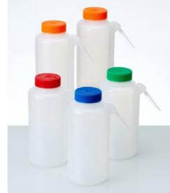
Azlon runde integrierte Spritzflaschen besitzen einen integrierten Ausgießer, der die Kontamination verringert, die durch das Innenrohr verursacht wird, wenn es während des Nachfüllens die Arbeitsfläche berührt.
